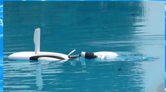
プールで採水する 水上ドローン採水装置
